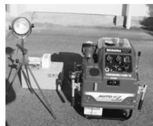
小型動力ポンプ
