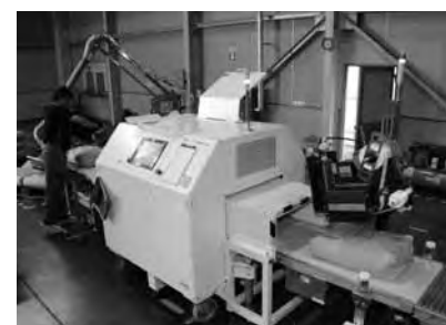
米の安全をチェックする検査機器
