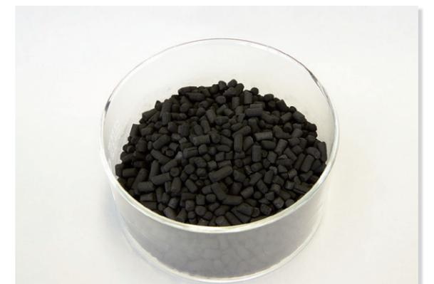
活性炭は、微細な孔が無数にあり、孔の壁が大きな表面積を作りだしているため多くの物質を吸着する性質があり臭気を通すと、臭気成分が細孔に入って出られなくなる（不純物を吸着する）ため、脱臭効果があります。
