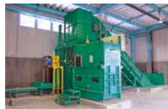
紙類圧縮梱包機 紙類を圧縮梱包します。
