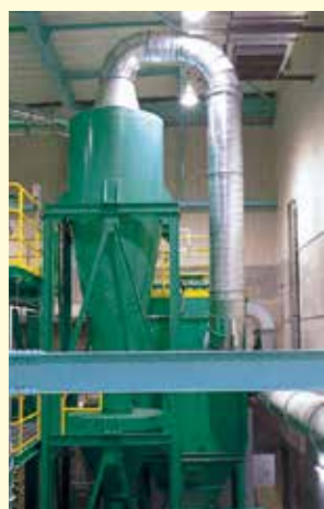
集塵装置 (サイクロン・バグフィルタ) 施設内の粉塵を捕集し、除去します。
