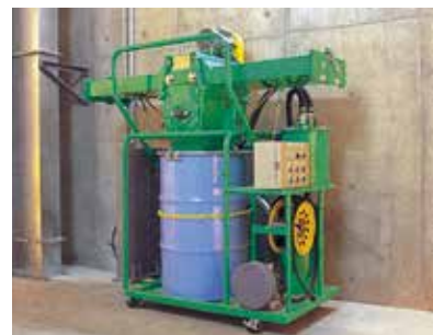
水銀回収装置 蛍光管を碎き、有害な水銀を回収する装置です。
