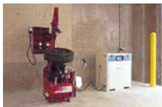
ホイール取りはずし装置 タイヤとホイールをはずします。
