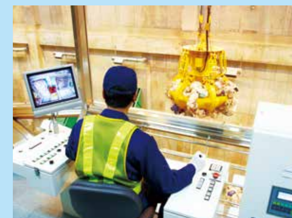
ごみクレーン操作
